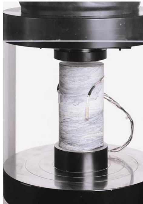
Detalle de muestra de roca con tres galgas extensométricas 82-P0392.
