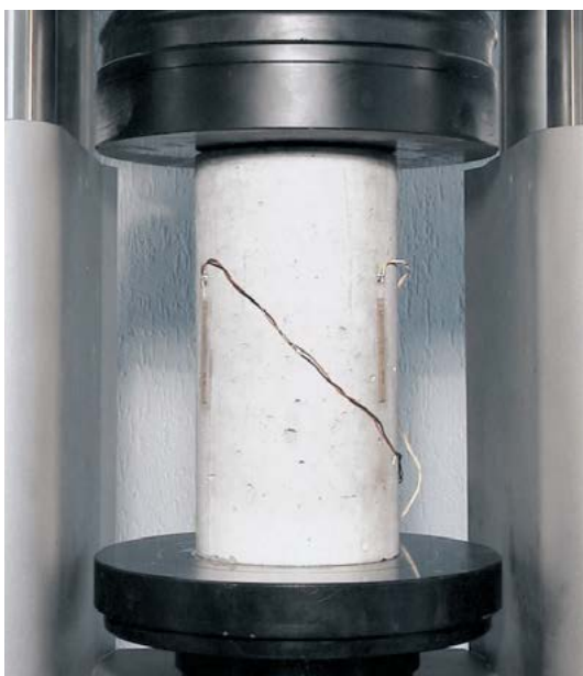
Determinación del Módulo Elástico usando galgas superficiales.
