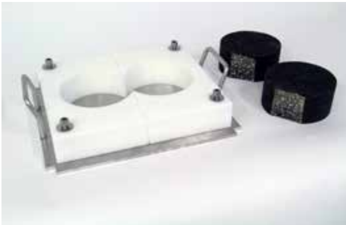
Juego de moldes para ensayar muestras de 6" (150 mm)
