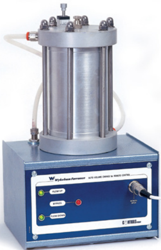
Misuratore automatico della variazione di volume per prove su campioni non-saturi
