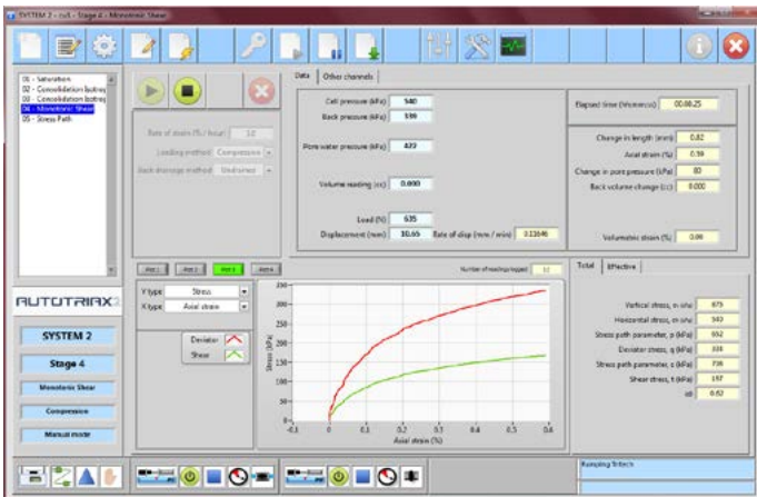
Diagramme déviateur et contrainte de cisaillement/ déformation axiale lors d'un cisaillement monotonique
