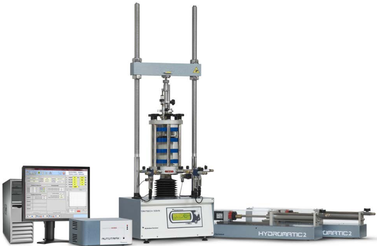
Configuration d'un système avec deux contrôleurs pression / volume Hydromatic2
