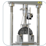
SCB - Semi-Circular Bend
