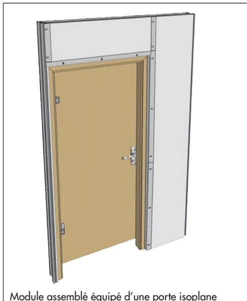
Module assemblé équipé d'une porte isoplane traditionnelle de 73cm. Le sens d'ouverture de la porte peut être choisi lors de la pose.
