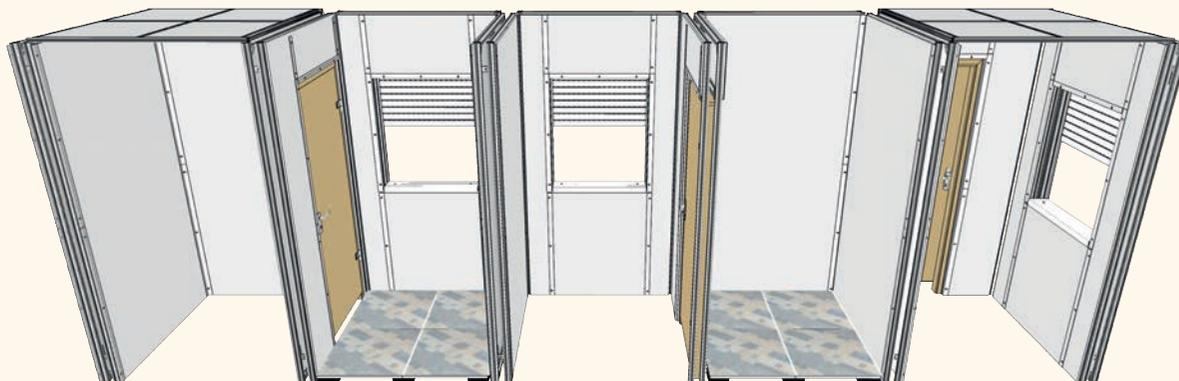
Vous pouvez créer un espace de multiples cellules de 1,2 x 1,2m. La juxtaposition de plusieurs éléments permet de créer un peigne au pas de 1,3m environ. Cette structure autoportante doit être fixée au sol.
