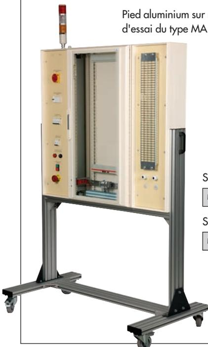
Pied aluminium sur roulettes dont 2 avec frein pour armoire d'essai du type MA. Dims du pied 1370 x 710 x H850mm
