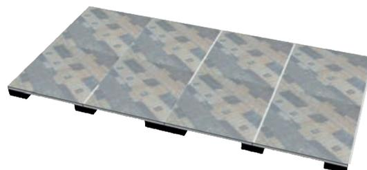
Le plancher technique est en plaques d'aggloméré hydrofuge permettant de passer des câbles sous la surface. Montage rapide sur plots souples ne nécessitant pas de réglage. Plaque de 600 x 600mm.
