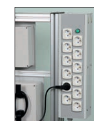
Prises à l'arrière du pupitre pour raccordement des modules
