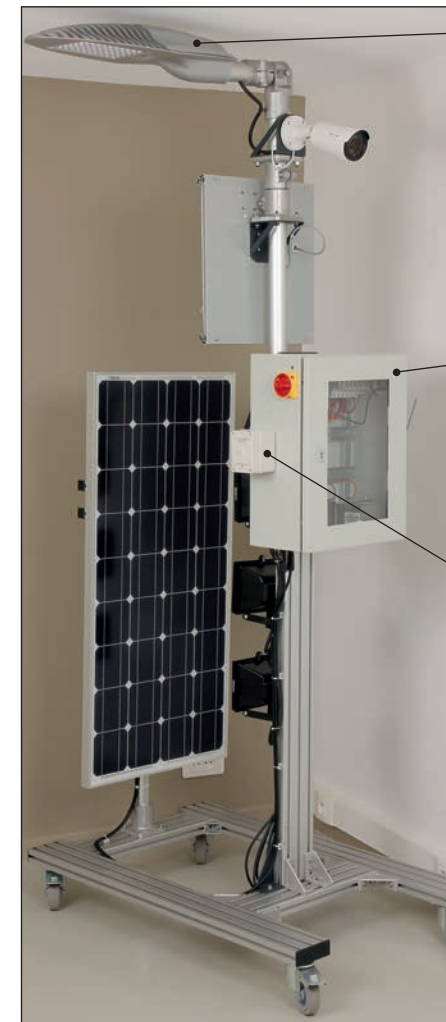
Panneau monocristalin 90Wc pivotant et orientable pour utilisation intérieure avec les 2 projecteurs fournis, extérieure avec une source solaire naturelle.
