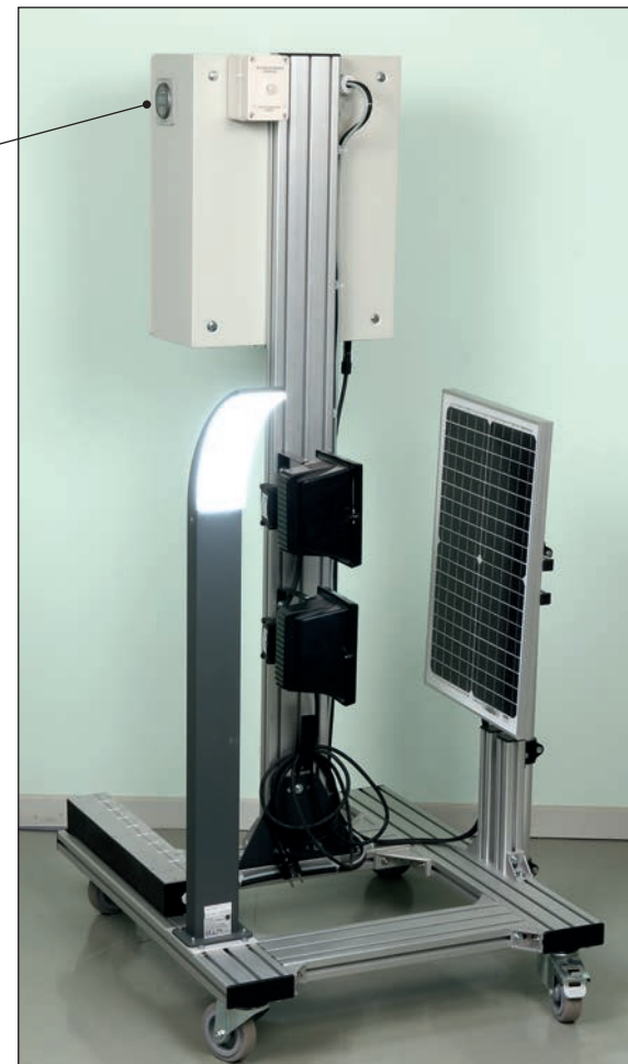
Panneau monocristalin 30Wc pivotant et orientable pour utilisation intérieure avec les 2 projecteurs fournis, extérieure avec une source solaire naturelle.
