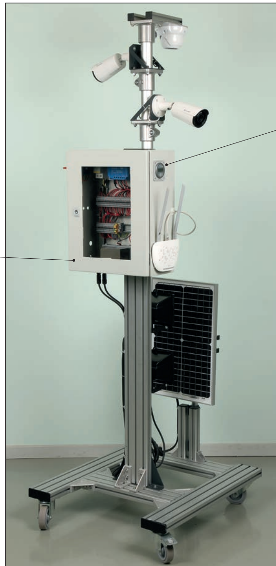
Panneau monocristalin de 80Wc pivotant et orientable pour utilisation intérieure avec les 3 projecteurs fournis, extérieure avec une source solaire naturelle.
